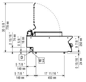
D Electrical inlet (power) ΕI Equipotential screw
